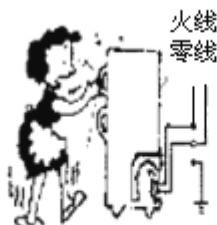
B. 电器金属外 壳未接地
