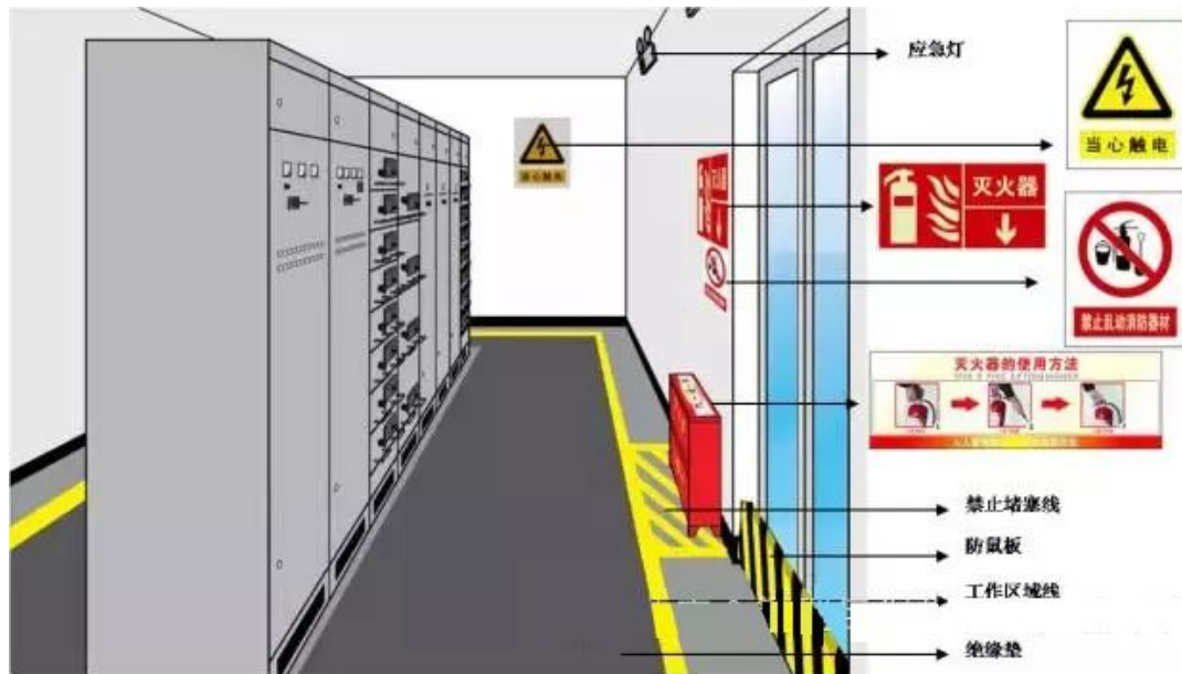
附配电间安全管理上墙看板
