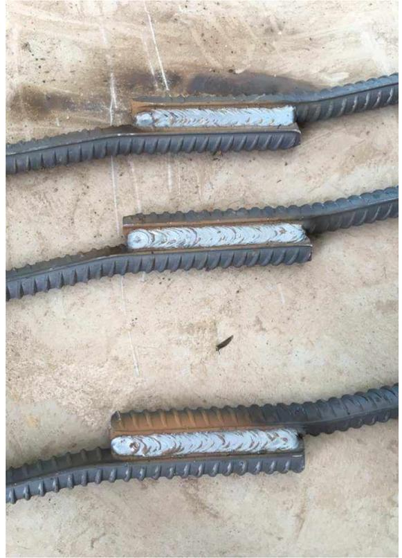
搭接焊送检时样品
