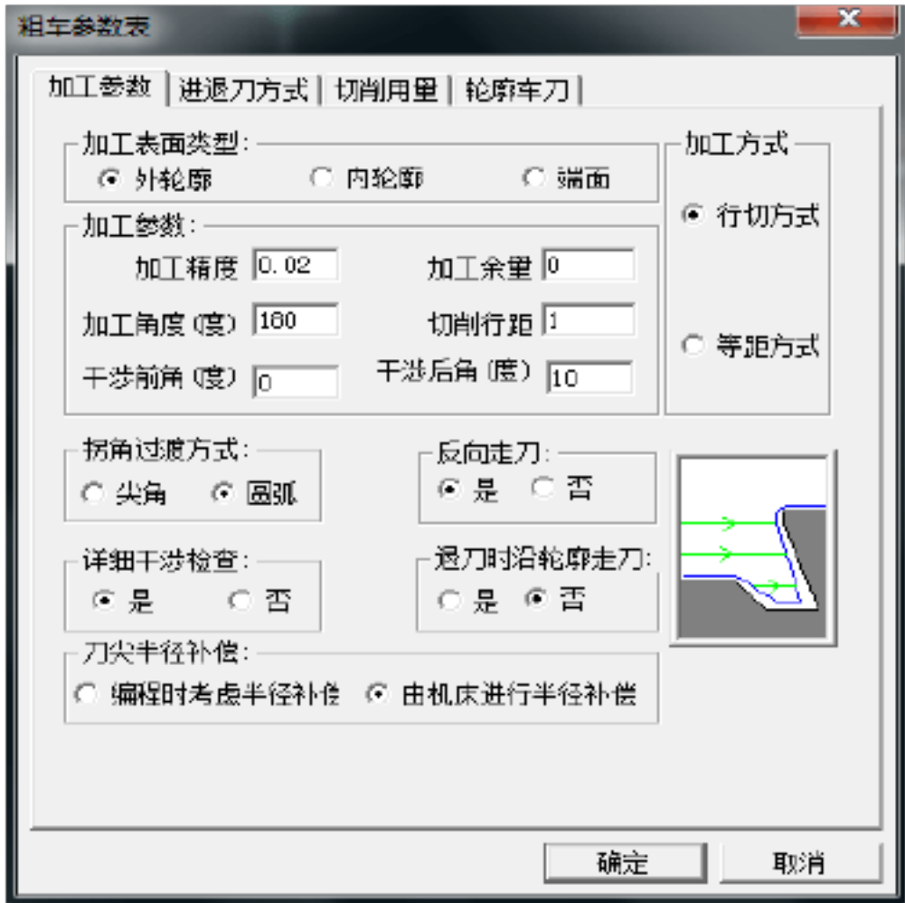
图 3-2 CAXA数控车床上选择加工零件的参数
