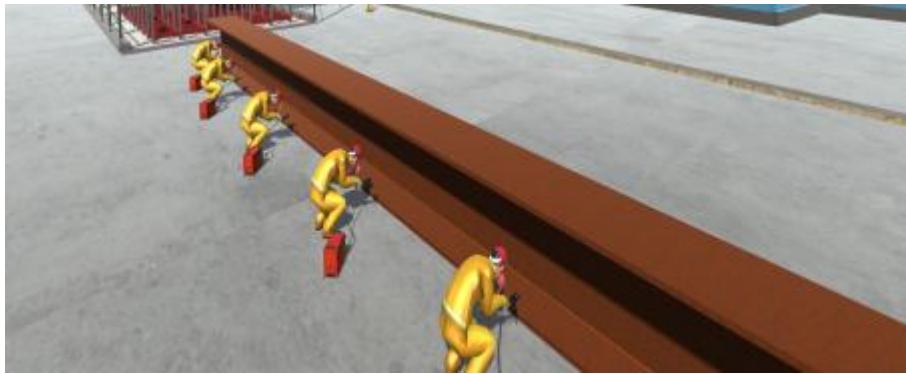
图 5.2.3-4 钢筋笼工字型钢摆放定位图
