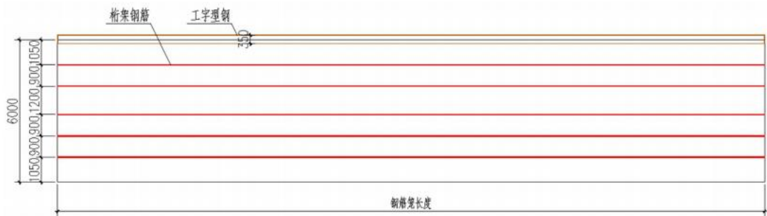
图 5.2.3-9 钢筋笼横向吊点布置
