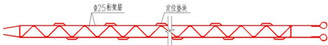
图 5.2.3-6 纵向桁架筋大样图
