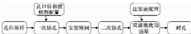
图 4.1.3 隧道内部地基注浆施工程序图
