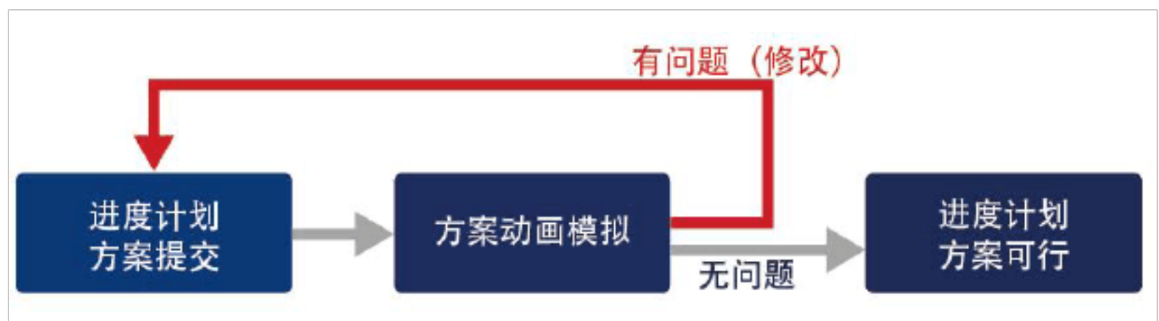
BIM施工进度优化流程
