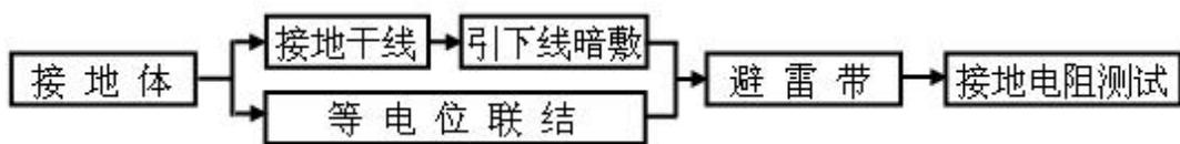
(1)、运用基本内钢筋做综合接地装置：按设计图尺寸位置规定，将柱四根 $\Phi 10\text{mm}$ 以上主筋底部与基本主筋、镀锌扁钢搭接焊好，形成基本接地网作为接地极。作为引下线柱子主筋与避雷带和接地极焊接，并在室外相应地面如下0.8米处预留 $40\times 4$ 热镀锌扁钢至散水以外与室外闭合环状接地体连接，当自然接地体不能满足规定期，增设人工接地。将四根主筋用色漆做好标记以便于引出和检查。及时请质检部门及监理进行隐检，同步做好隐检记录。
