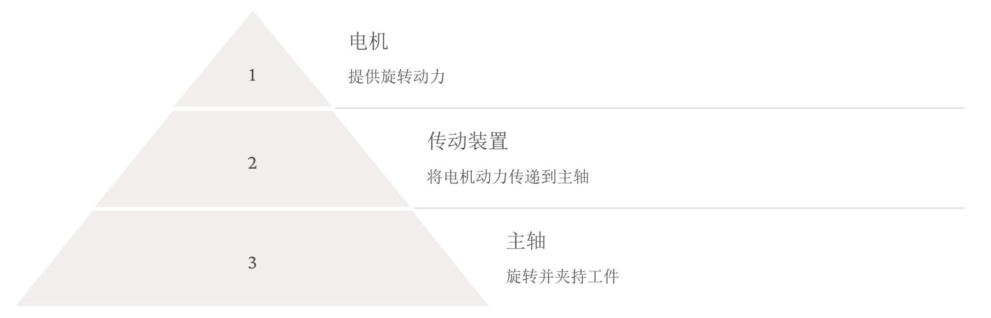
**50**系统机床的主轴驱动系统由电机、传动装置和主轴组成。电机提供旋转动力,传动装置将电机动力传递到主轴,主轴负责旋转并夹持工件。
