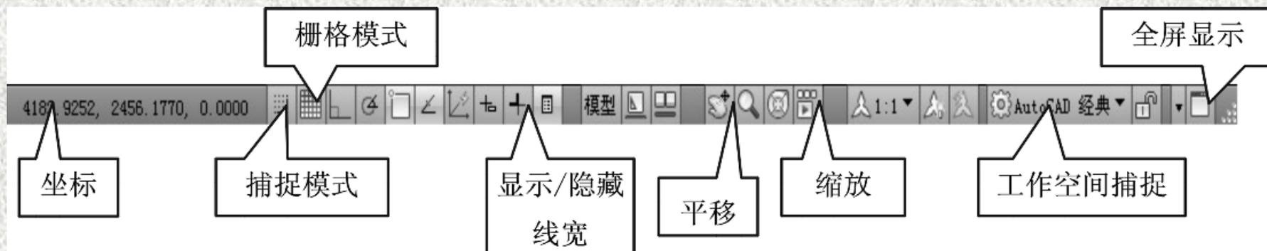
图1-10 AutoCAD 2010状态栏
