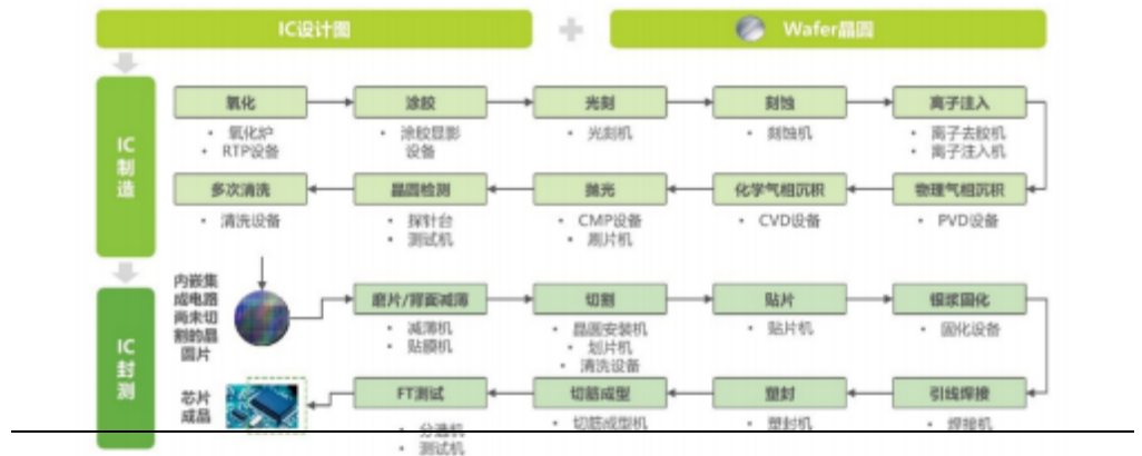
图表 1 半导体工艺流程与设备
