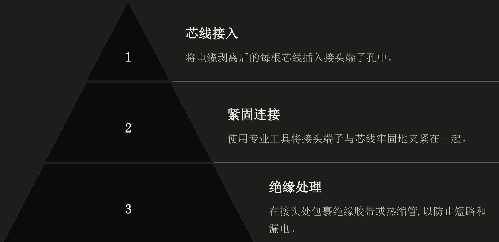
接头安装是电缆连接的关键一步。首先需要将剥离后的每根电缆芯线插入接头端子孔中, 确保连接牢固。然后使用专业工具将芯线与接头端子紧紧地夹在一起。最后在接头处进行绝缘处理, 以确保接头连接安全可靠。整个过程需要小心操作, 确保每个步骤都得到正确执行。
