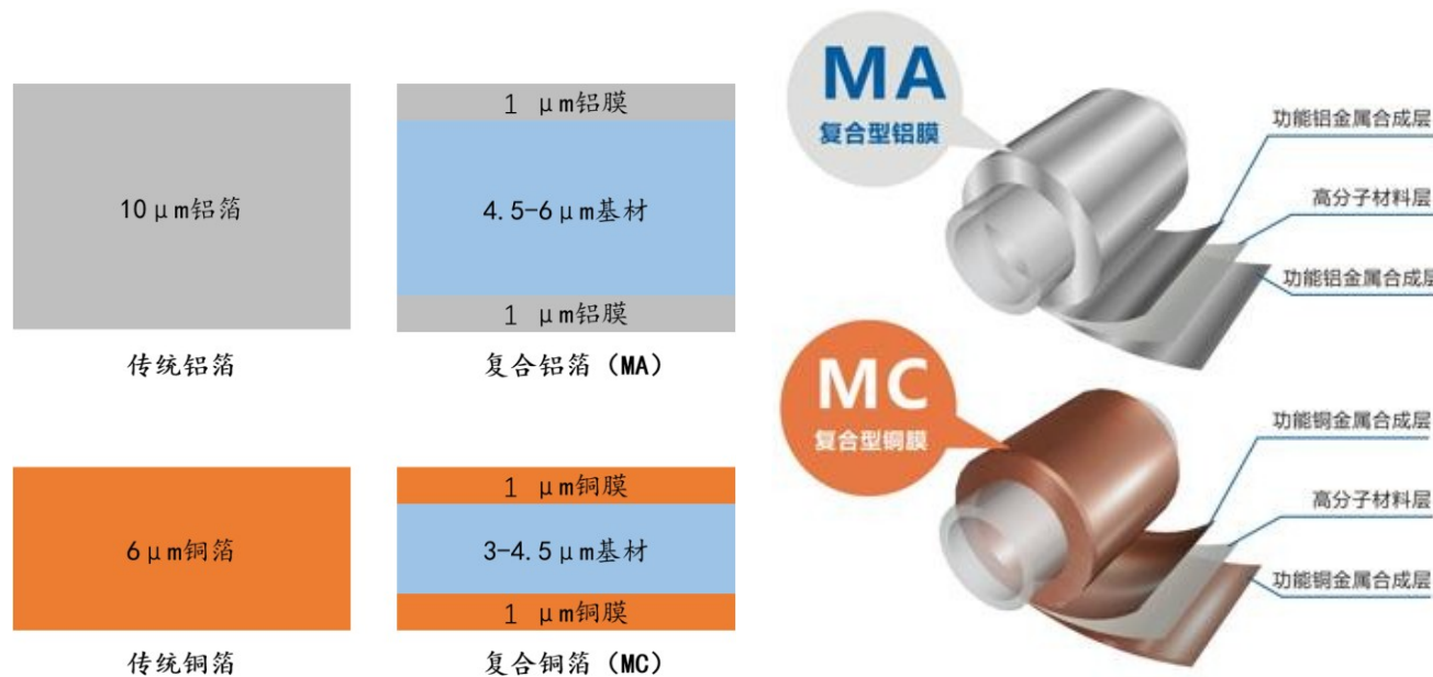
图：传统箔材与复合铜箔（MC）、铝箔（MA）结构对比
