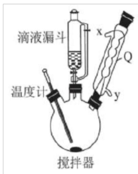
步骤 1：称取 94.5g(1.0mol)  $\text{ClCH}_2\text{COOH}$  于 1000mL 三颈烧瓶中(如图)，慢慢加入 50%  $\text{Na}_2\text{CO}_3$  溶液，至不再产生无色气泡；
