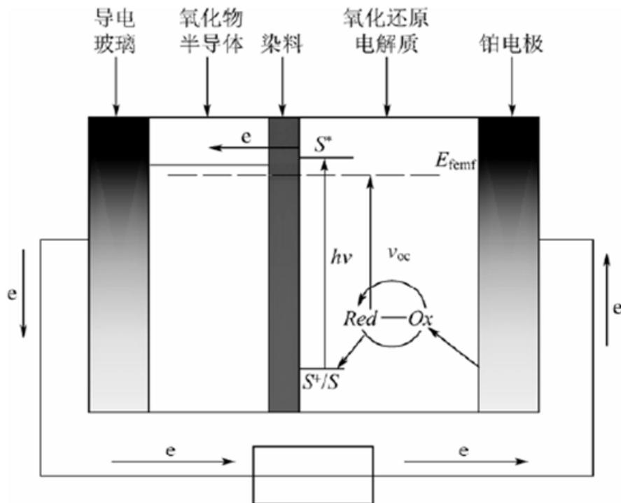
当太阳光照射在染料敏化太阳能电池上, 染料分子中基态电子被激发, 激发态染料分子将电子注入到纳米多孔半导体的导带中, 注入到导带中的电子迅速富集到导电玻璃面上, 传向外电路, 并
