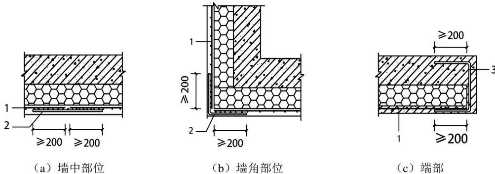
图 6.2.4-1 防护层钢筋焊接网水平搭接
