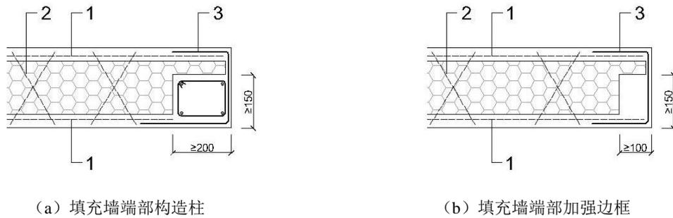
图 6.3.5 CL 复合填充墙端部构造做法
