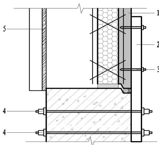
图 7.5.5 CL 预制板安装及单侧模板支设
