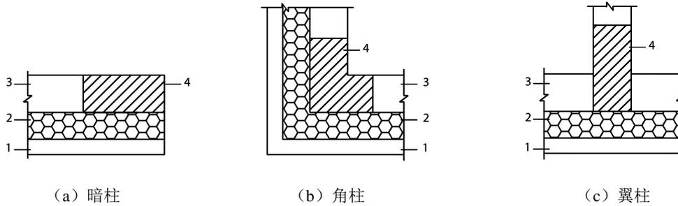
图 5.2.3-1 CL 复合剪力墙边缘构件位置
