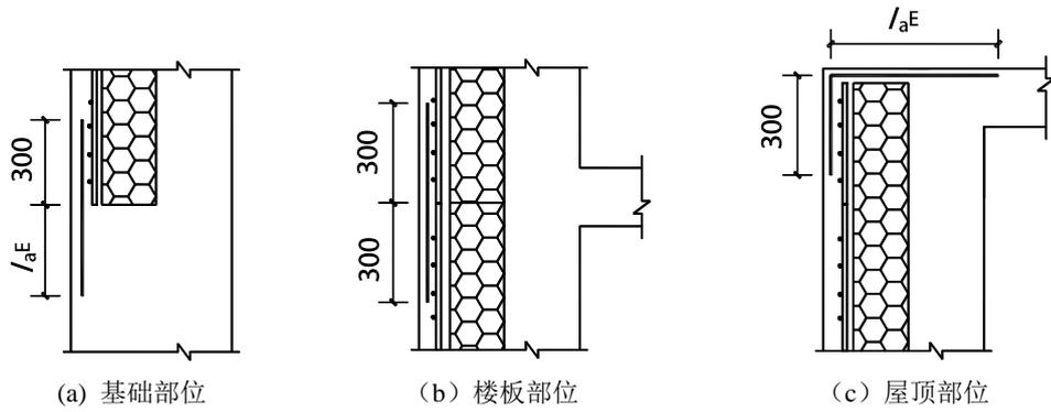
图 6.2.4-2 防护层钢筋的竖向连接
