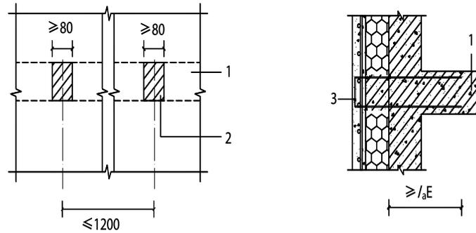
图 6.2.3 楼（屋面）板处混凝土连接点
