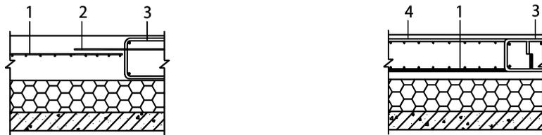
(a) 受力钢筋焊接网附加绑扎钢筋
