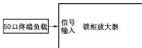
图 13 输入噪声校准连接示意图
