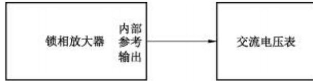
图 4 10 Hz~4 MHz内部参考源输出幅度校准连接示意图
