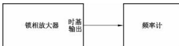
图 2 时基输出频率校准连接示意图
