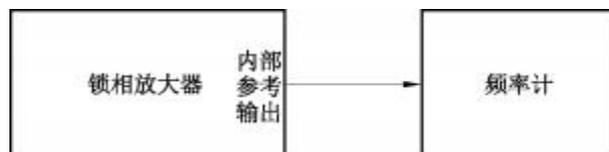
图 3 内部参考源输出频率校准连接示意图
