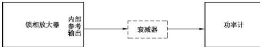
图 5 4 MHz~600 MHz内部参考源输出幅度校准连接示意图
