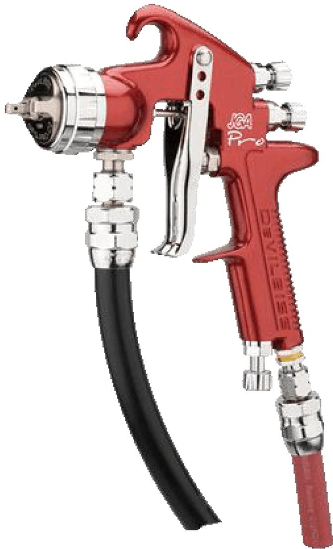
HVLP (High Volume Low Pressure) 是高流量低压力 的英文缩写，HVLP 喷枪即为所谓的低压环保喷枪。与传统喷枪相比，HVLP 喷枪主要是通过系列特殊的设计，对喷枪风帽（空气喷嘴）气压进行了优化，雾化气压不高于 70kpa，而传统喷枪的风帽气压为 250—300Kpa。通过风帽处气压的改变，HVLP 喷枪大大减少了产统喷枪过度雾化的现象，降低了溶剂和涂料的散失，提高了涂料的传递效率（涂料的有效利用率：传统喷枪为百分之 30-40，HVLP 喷枪为百分之 65 以上，静电喷涂效率更可达百分之 85 以上）。
