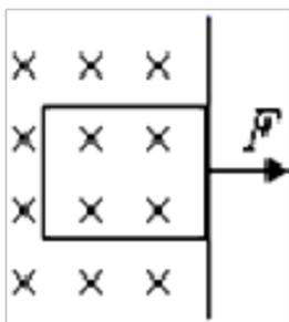
19. (0分)[ID: 128592]把一个矩形线圈从有理想边界的匀强磁场中匀速拉出(如图), 第一次速度为  $v_1$ , 第二次速度为  $v_2$ , 且  $v_2 = 2v_1$ , 则前、后两种情况下安培力之比\_\_\_\_, 拉力做功之比\_\_\_\_, 拉力的功率之比\_\_\_\_, 线圈中产生的焦耳热之比\_\_\_\_, 通过导线横截面的电量之比\_\_\_\_.
