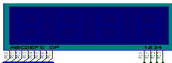
图 10 七段 LED 数码管显示模块的管脚连接图
