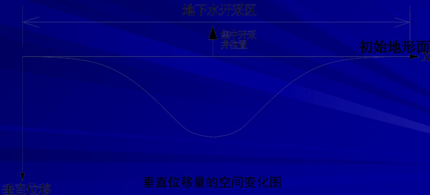
由于垂直应变不均匀，在沉降区中心，两侧土体会向中心挤压，产生剪切破裂面，地面出现地裂缝。
