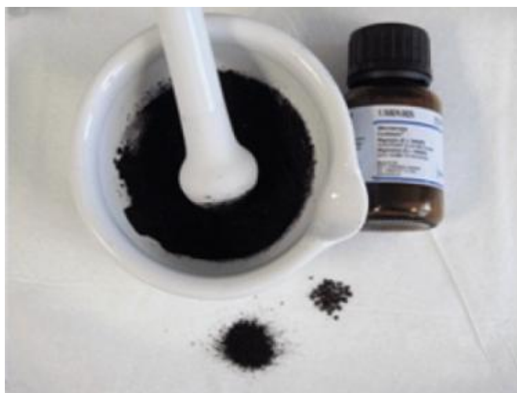
图3 大颗粒的苯胺黑在化学研磨钵中研磨
