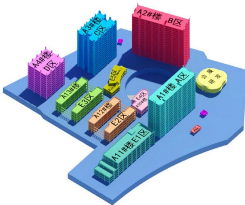
图 4.3-2 地上施工流水段
