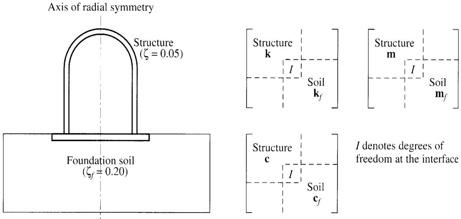
可以分别采用Rayleigh阻尼构造各子结构的阻尼矩阵，再组合形成体系的总体阻尼阵。
