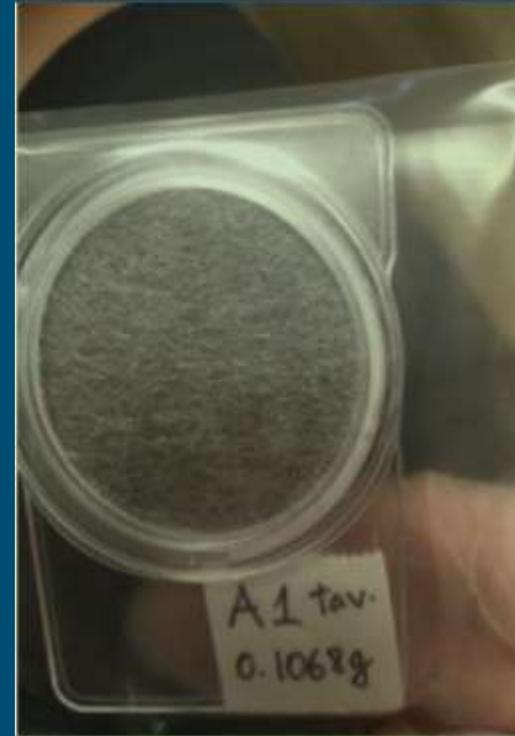
A1 滤膜上显示的是收集到的小圆块在内嵌的过滤器支架上
