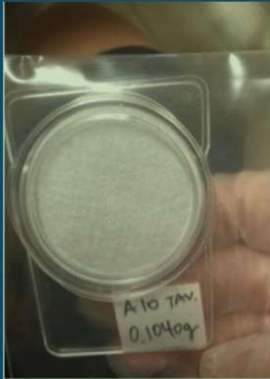
A10滤膜是来自在线过滤器支架的采样杯（收集实验室环境空气）
