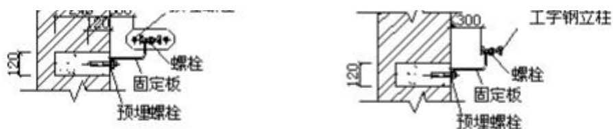
工字钢立柱直立式用固定板做法
