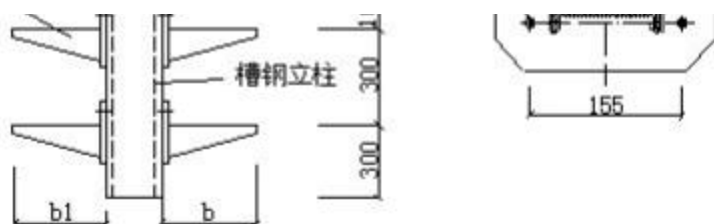
图12.3.1.5(4f)槽钢、角钢立柱悬吊安装
