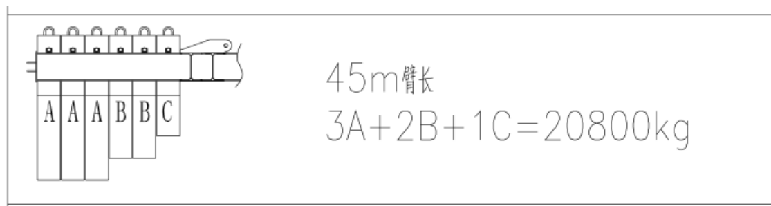
图 6.6-24 臂长 45m 平衡重的规格和数量
