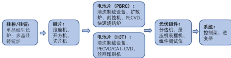
A. 硅片制造。首先原料硅砂（二氧化硅）经纯化过程冶炼出太阳能发电级的多晶硅，再将多晶硅材料加工成硅晶片；
