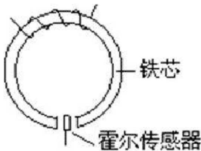
图2-2霍尔传感器测电流示意图
