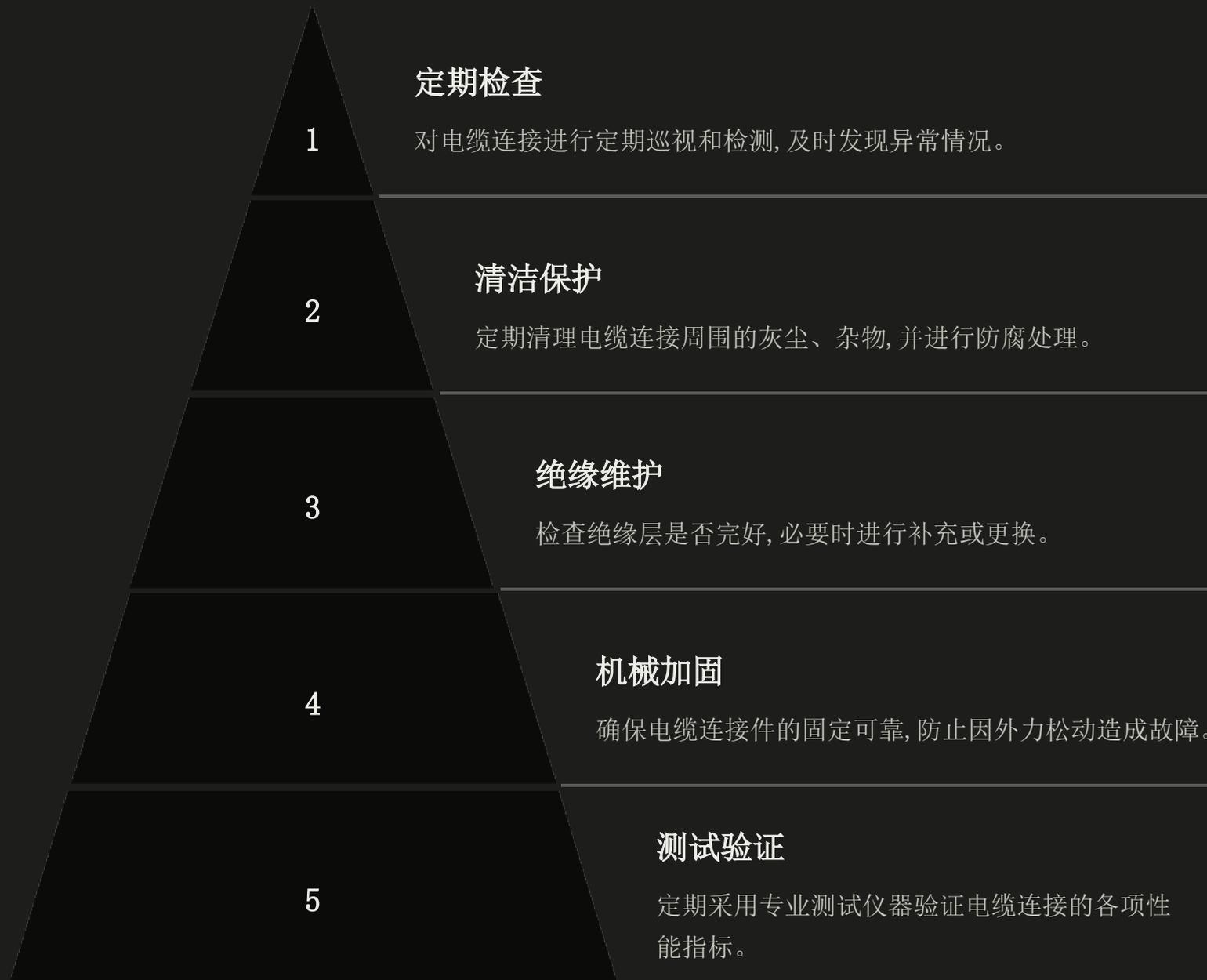
电缆连接的维护保养对于保障电力系统安全运行至关重要。要从定期检查、清洁保护、绝缘维护、机械加固以及性能测试等多方面入手, 确保电缆连接处于良好的技术状态, 杜绝安全隐患的发生。
