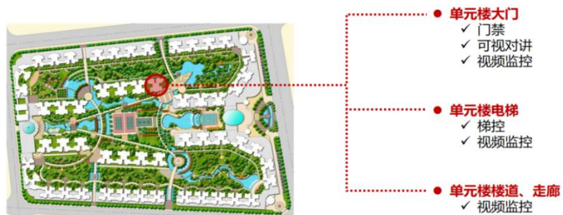
图 3.3 安防监控安装位置图
