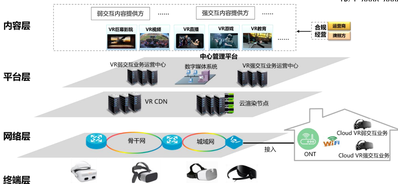
图1 云化虚拟现实总体技术架构
