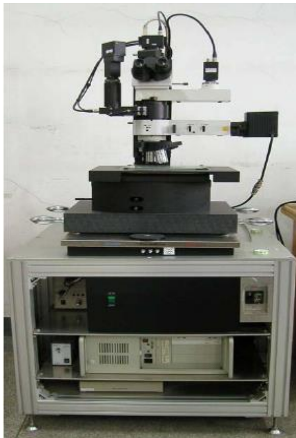
图 3-4 HSP-1000 高速成像显微镜
