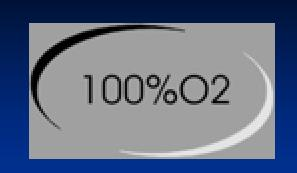
■ 100% 02 特殊功能可以在所有的通气模式下进行。按下前板面上的 100% 02 键即将其开启。吸入气的在5 分钟内为100% 02 ,然后恢复到原来设定值。 100% 02使用屏幕上都会有提示,在100% 02 输送时间未结束之前,按下100% 02 键可将该功能关闭
