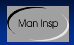
B 按下手动吸气(Man Insp)键,在下一个呼气期间立即开始一次指令通气。如果持续按住该键,紧接着会有多次机械通气。如果按Man Insp 键,显示器上会显示为手动Manual 的提示。
