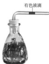
图 1 注:瓶中溶液可保证容器内二氧化碳浓度恒定
