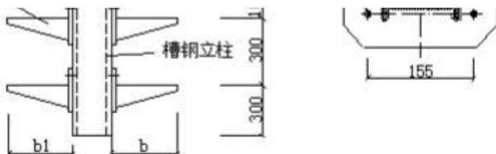
图12.3.1.5(4f)槽钢、角钢立柱悬吊安装
