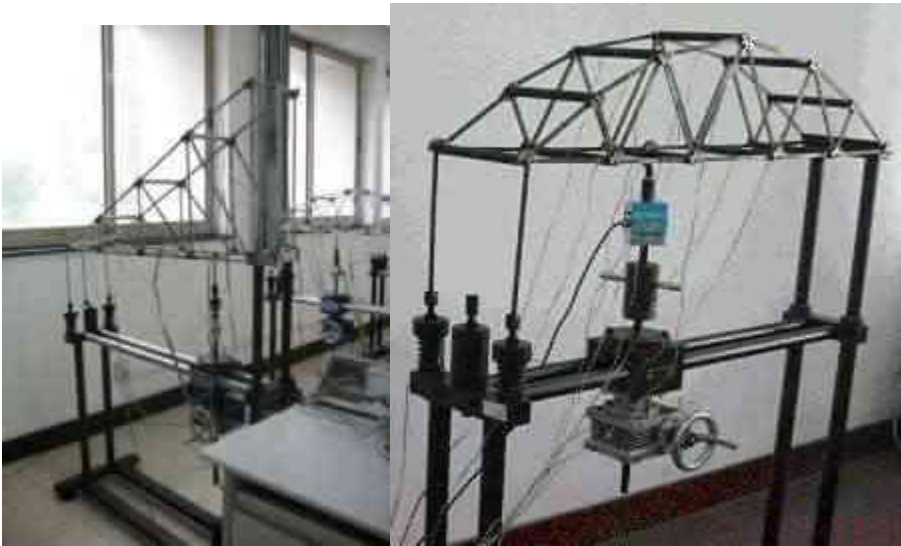
(a) 拱式刚架 (b) 三角式刚架
