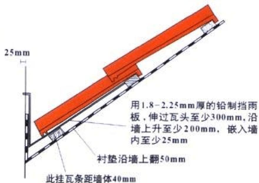
3. 最上方挂瓦条距墙面 40mm.
