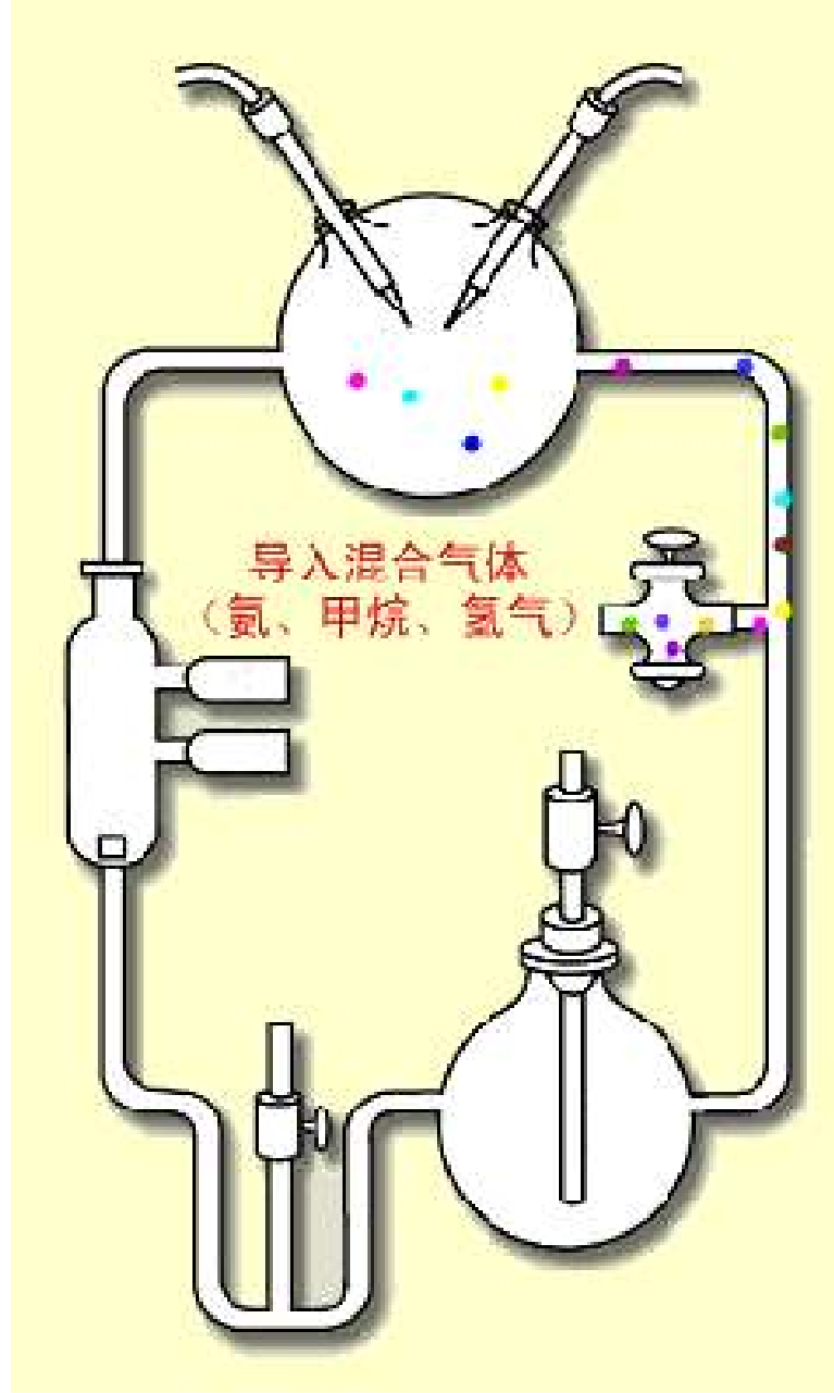
模拟原始大气层之有机合成的实验装置
