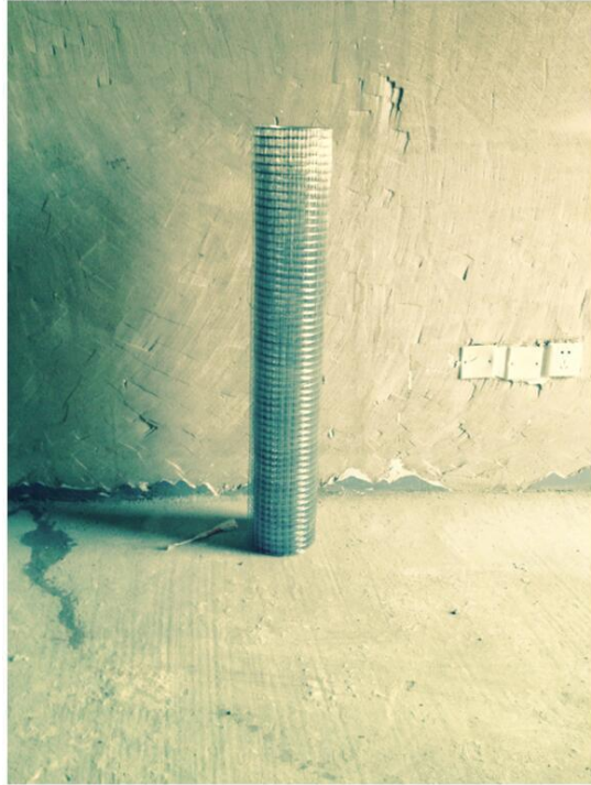
轻体墙防开裂的铁丝网
