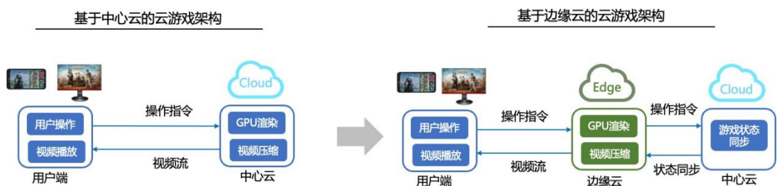
图 3 中心云游戏架构与边缘云游戏架构
