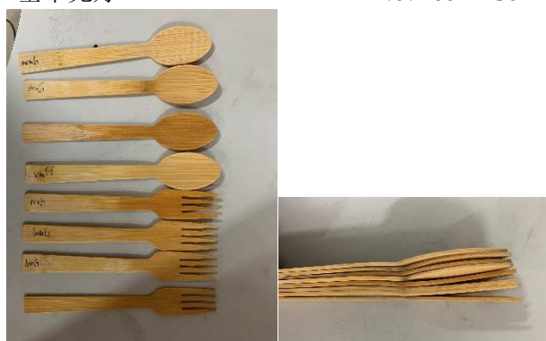
(e) 60℃ 60min 勺子留有弧度 竹叉趋于平直
