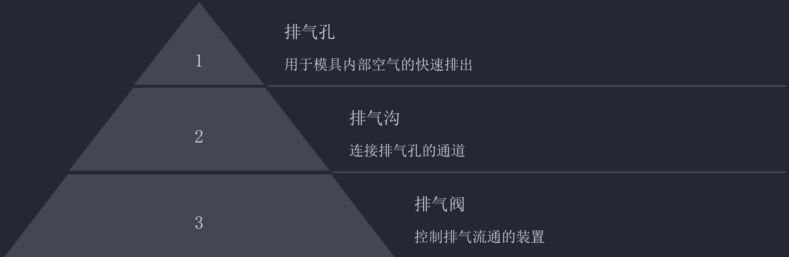
注塑模具的排气系统是一个重要的组成部分,它的作用是确保模腔内部的空气可以快速排出,避免气体滞留造成成型缺陷。排气系统主要由排气孔、排气沟和排气阀等部件组成,通过合理设计和布置,可以确保成型件表面无气痕、无涡纹等问题。
