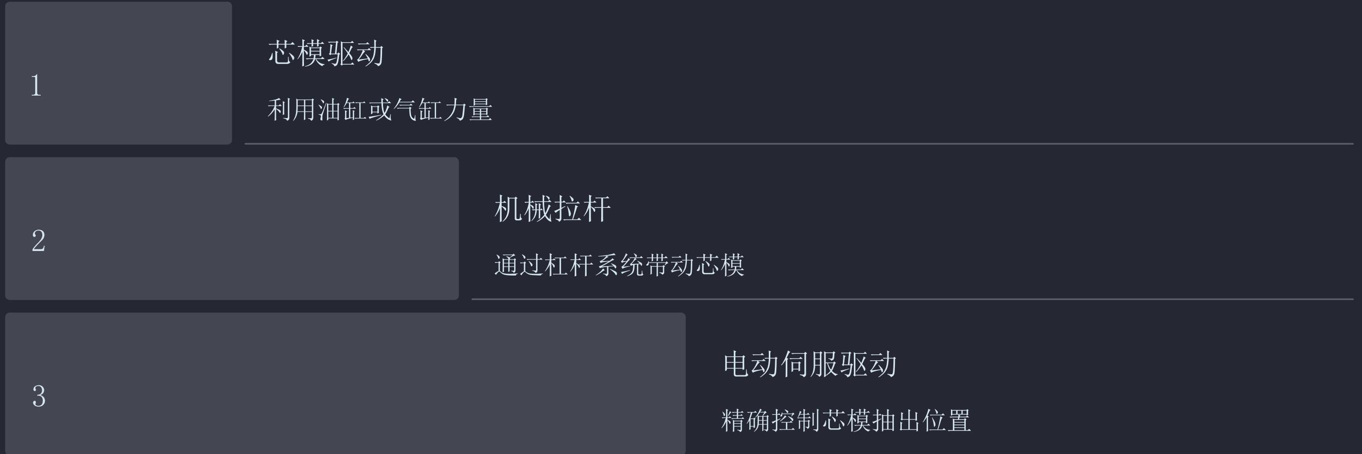
注塑模具的抽芯机构是用于带动芯模(也称为抽芯)沿一定路径往复运动的关键机构。常见的抽芯机构包括芯模驱动、机械拉杆和电动伺服驱动等。这些机构能可靠地完成在注塑过程中将芯模快速拉出、成型件脱离模具腔腔壁的动作。合理设计抽芯机构是确保注塑产品质量的重要一环。
