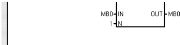
图 3-11 网络 9 梯形图如图 3-11 网络 9 梯形图定时器 T33 发出信号，控制步进电机向右移位 1 个字节。
