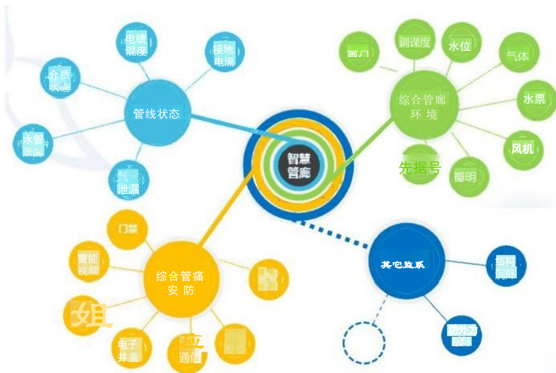
图4综合监控系统
