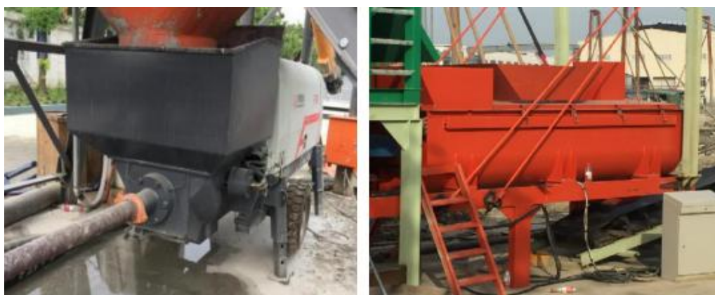
图 5.2.6-2 履带式行星搅喷机浆液搅拌输送系统示意图
