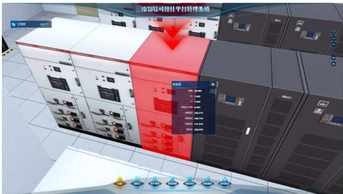
(配电柜告警变色)
