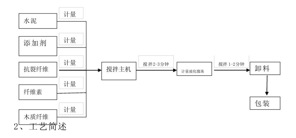
因玻化微珠是闭孔的,如破裂后将会增加它的比重, 降低它的保温性能。所以生产过程中的投料顺序必须根据 玻化微珠易碎的材料性质来进行:计量后的水泥、粉煤灰 及添加剂先投入搅拌主机中进行初搅拌,搅拌 2~3 分钟后 再投入计量好的玻化微珠,继续搅拌 1~2 分钟后即可卸料 进行包装。
