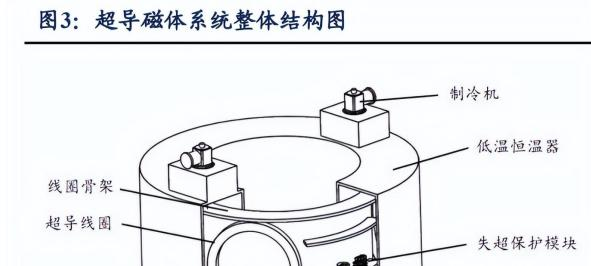
超导磁体具有磁场强度高、重量体积小、节省电耗等核心突出优势。通常电磁铁是 利用在导体中通过电流产生磁场,由于超导材料在低于某一极低温度下具有零电阻特性, 因此相比于常规磁体,超导磁体可以在不损耗焦耳热的情况下,产生很高的运行电流, 进而在大空间内产生高场强、高稳定性、高均匀性的磁场。
