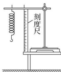
2.在弹簧下悬挂一个钩码,平衡时记下弹簧的总长度  $l_1$  和钩码的质量  $m_1$ 。将数据填入表格。
